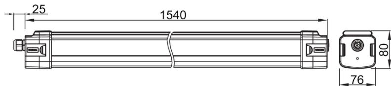
Die Leuchten PROFILINE IP sind für raue Einsatzbedingungen im Innen- und Außenbereich konzipiert und liefern mit bis zu 150lm/W eine sehr hohe Lichtausbeute bei gleichzeitig langer Lebensdauer. Es werden ausschließlich Marken-LEDs und hochwertige Vorschaltgeräte verbaut. Die Ausführung mit Optik-Arrays eignet sich für größere Montagehöhen, die klare Abdeckung besteht aus bruchsicherem Polycarbonat.
