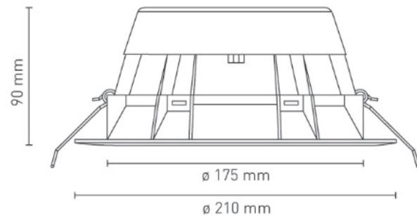
Hocheffizientes LED-Downlight für den Einsatz in Büros, Hotels oder Fluren. Die Leuchte ist blendfrei durch ihre tief liegende spezielle Diffusorscheibe. Sie bietet ein sehr gutes Wärmemanagement für eine lange Lebensdauer, werkzeuglose Montage in Standard-Bohrungen Ø 175-200mm durch Klemmfedern, Energieeffizienzklasse A+.
