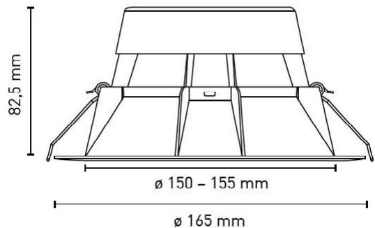
Hocheffizientes LED-Downlight für den Einsatz in Büros, Hotels oder Fluren. Die Leuchte ist blendfrei durch ihre tief liegende spezielle Diffusorscheibe. Sie bietet ein sehr gutes Wärmemanagement für eine lange Lebensdauer, werkzeuglose Montage in Standard-Bohrungen Ø 150-155mm durch Klemmfedern, Energieeffizienzklasse A+.
